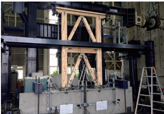
壁倍率20倍相当の水平加力試験の様子。ホールダウン金物25kNは大地震時には終局耐力として50kNがかかる。柱の両側に25kNを配置するケースを考えると100kNの引き抜きがかかることもあり得る(写真提供:ウッド・ハブ)
