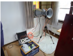
築27年の既存住宅を気密測定しているところ。既存建物の現状を知るうえで非常に有効な検査
