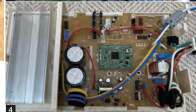
1 シングルロータリーのコンプレッサー。主に普及価格帯の機種に採用されている 2 ツインロータリーのコンプレッサー。容量が大きいため能力を高く設定できる。上位機種に採用されている 3 室内機の熱交換器。最近の機種は高効率化するために面積が大きくなっている 4 インバータの基盤。コンプレッサーのモーターを負荷に合わせてきめ細かく制御することで高効率化に寄与する
