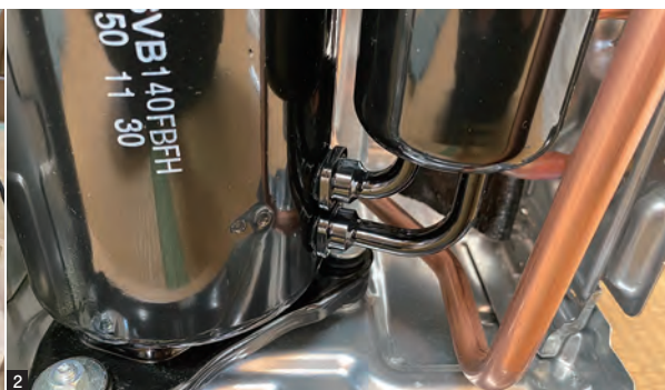
1 シングルロータリーのコンプレッサー。主に普及価格帯の機種に採用されている 2 ツインロータリーのコンプレッサー。容量が大きいため能力を高く設定できる。上位機種に採用されている 3 室内機の熱交換器。最近の機種は高効率化するために面積が大きくなっている 4 インバータの基盤。コンプレッサーのモーターを負荷に合わせてきめ細かく制御することで高効率化に寄与する
