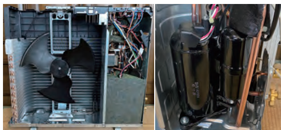
三菱電機 HXV シリーズ 2.8kW の室外機。いわゆる寒冷地対応エアコン。吸音材の背後にツインロータリーのコンプレッサーがある。ファンとコンプレッサーの動作音が主な室外機の騒音源(左)。ツインロータリーのコンプレッサー。能力が高いため回転数が抑えられるため動作音が安定している(右)
